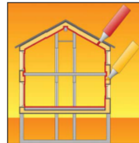
Rys. 1 Ciągłość izolacji cieplnej i powłoki szczelnej powietrznej (autor Mario Bodem)
