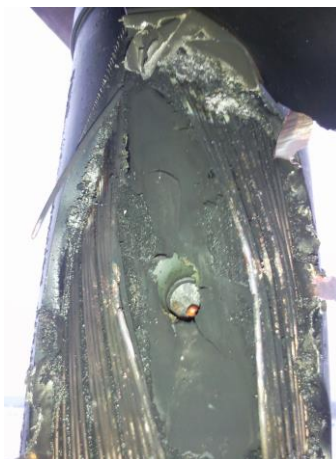
Rys. 2 Widok miejsca przebicia kabla
